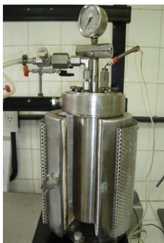
**Figura 2** – Reator MAITEC usado durante o processo de hidrólise
