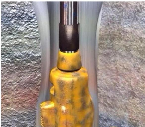
Figura 1: Esquemática da prisão da coluna de perfuração.
