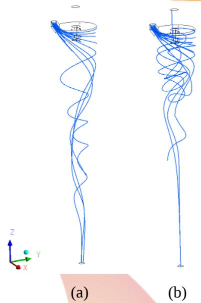
Figura 2: Linhas de fluxo da água para as velocidades de (a) 4 m/s e (b) 32 m/s.
