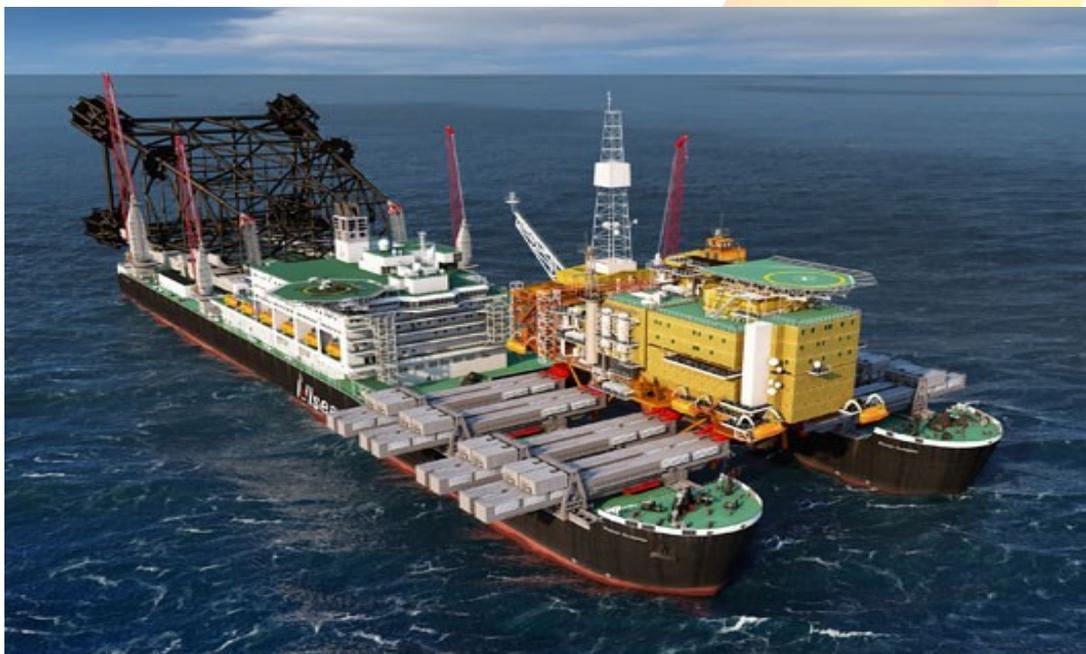
Figura 4: Embarcação *Pioneering Spirit* transportando o *Topside* e a estrutura submarina de plataforma de petróleo desativada.
