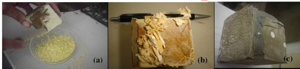
Figura 1- Camada degradada raspada (a) em pasta convencional e compósitos cimento/poliuretana em pó, (b) compósito cimento/poliuretana aquosa não iônica W320 e (c) interface de cor marrom. Fonte: NÓBREGA et al. , 2007
