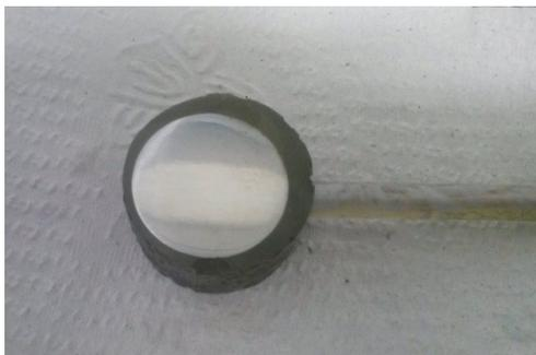
Figura 6 – Lixamento da amostra.
