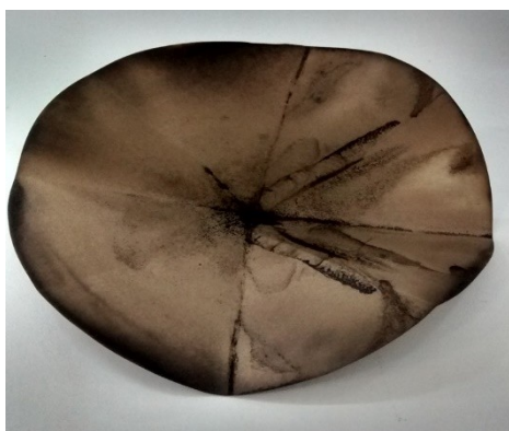
Figura 3: Papel filtro com os asfaltenos extraídos a partir do método utilizando o extrator.
