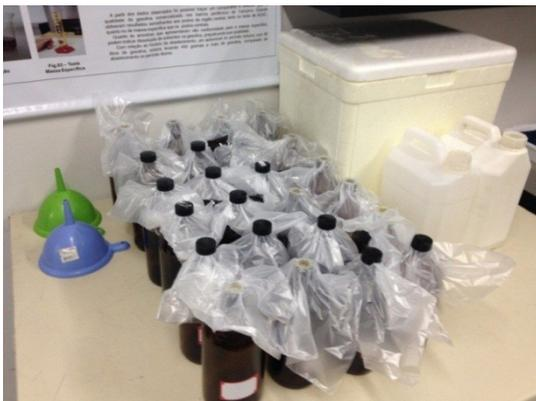
Figura 1: Material para coletas das amostras testemunhos de gasolina.
