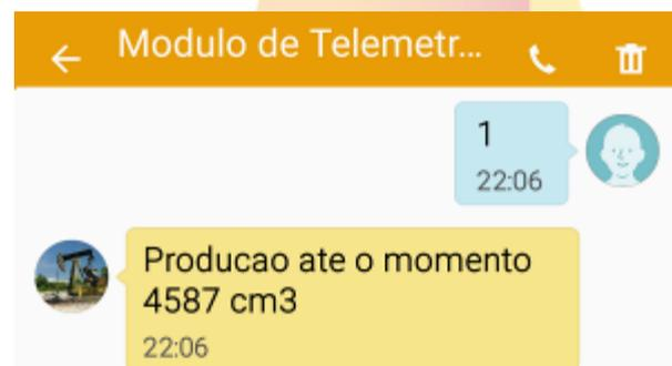
Figura 7 – Solicitação do valor produzido por parte do supervisor do processo.
