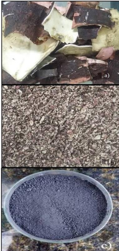
Figura 2: a) Fibra da macaxeira após a exposição solar; b) Fibra da macaxeira seca e triturada e c) Carvão ativado da macaxeira.
