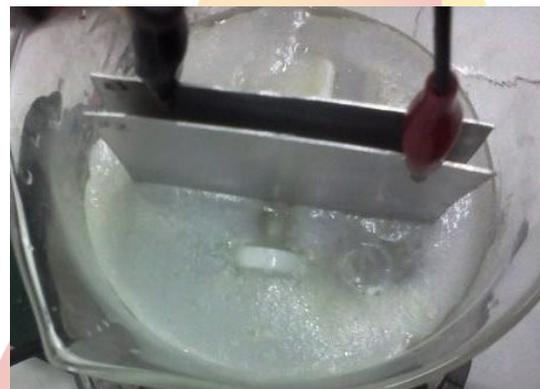
Figura 3: Fotografia da visão superior do reator contendo material flotado.
