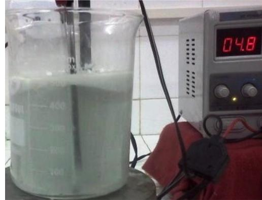
Figura 2 - Fotografia do reator eletroquímico em funcionamento.
