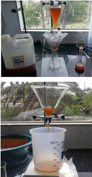
**Figura 1: (a) Recipientes de armazenamento e método de filtração utilizando papel filtro. (b) Filtração do óleo de fritura utilizando fibra de algodão.**
