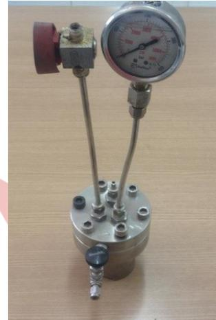
**Figura 2: Reator utilizado nos testes catalíticos.**
