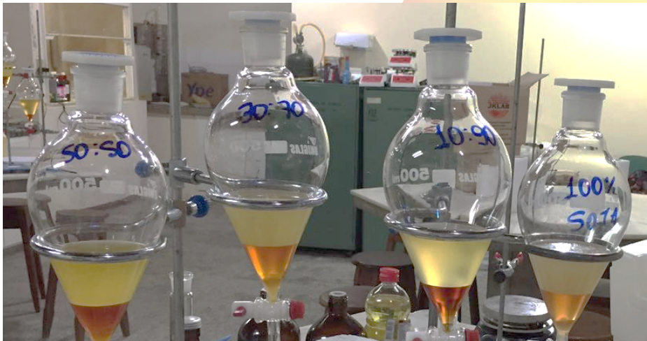
Figura 02: Separação das fases após produção dos experimento de biodiesel. Fonte: arquivo pessoal.
