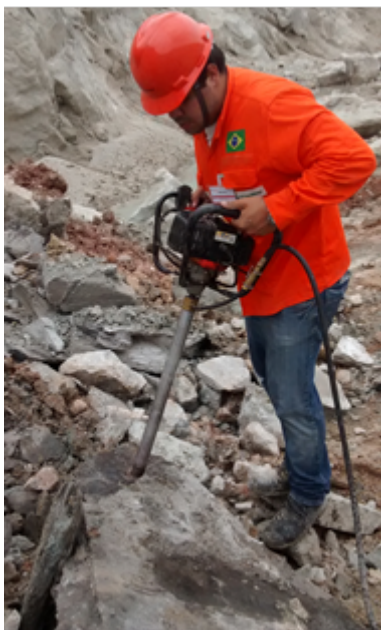
Figura 3: Extração de plugues na Formação Morro do Chaves.
