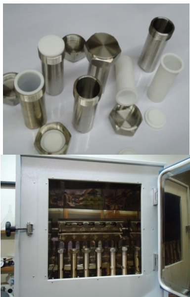
Figura 2. Autoclaves de aço inoxidável revestidas com teflon e a estufa com agitação.
