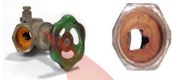
Figura 2: Incrustação em uma válvula.
