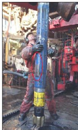
Figura 5: Posicionamento dos Pistões Defletores Fonte: BAKER HUGHES [2009]
