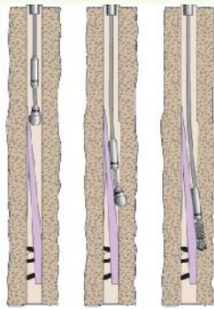
Figura 2: Whipstock em sidetrack Fonte: ROCHA [2008]
