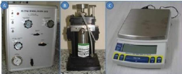
Figura 3:(a) UltraPoroPerm 500, (b) Copo matriz e (c) Balança semi-analítica
