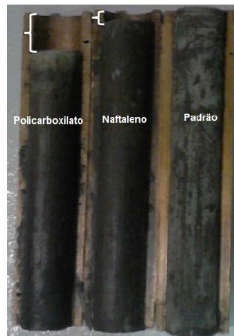
Figura 11: Rebaixamento de topo
