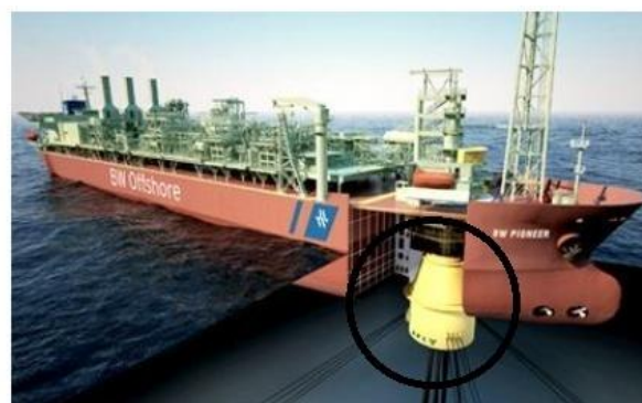
Figura 4: Turrete de uma unidade do tipo FPSO.
