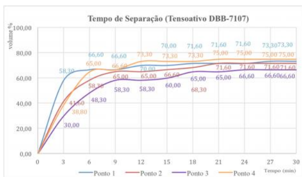
Figura 16: Percentual de quebra da emulsão de petróleo versus tempo, para a microemulsão utilizando o tensoativo DBB 7107.
