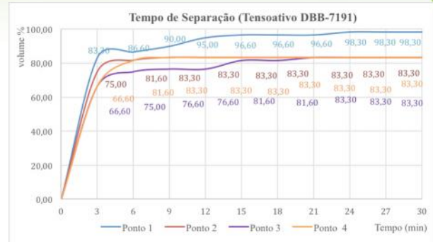
Figura 17: Percentual de quebra da emulsão de petróleo versus tempo, para a microemulsão utilizando o tensoativo DBB 7191.
