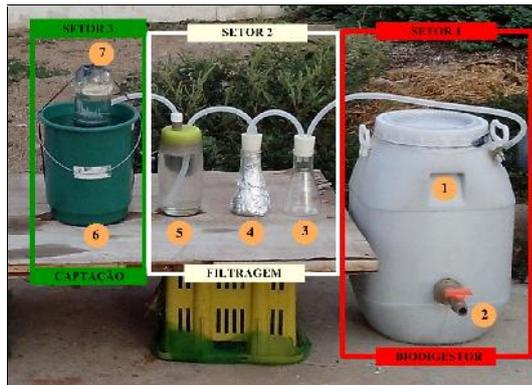
Figura 1: Apresentação e esquematização do sistema de biodigestão anaeróbia. Fonte: Imagem do próprio Autor, 2014.
