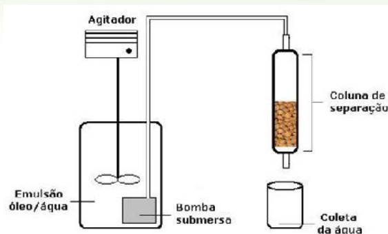
Figura 3: Esquema do sistema utilizado na separação óleo/água [SILVA, 2005]
