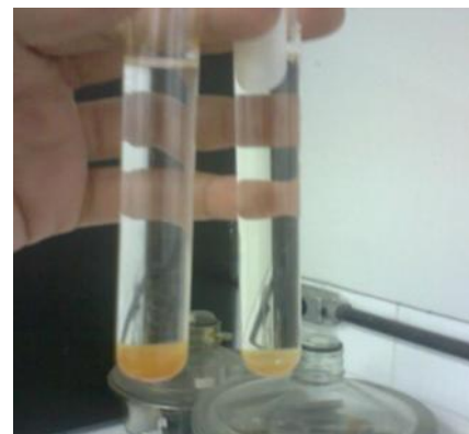
Figura 4 – O primeiro tubo mostra o processo Fenton neutralizado com Na 2 S 2 O 3 e NaOH e o segundo mostra o processo Fenton neutralizado com CaO.
