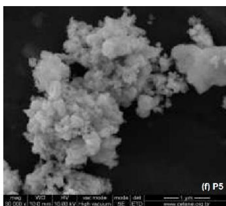
Figura 4 – Micrografias obtidas por MEV para as amostras de catalisadores de composição Ce_{1-x}Cu_xO_2 sintetizadas pelo método Pechini.
