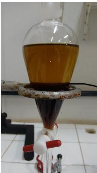
Figura 2: Biodiesel produzido com óleo de canola neutralizado com NaOH.
