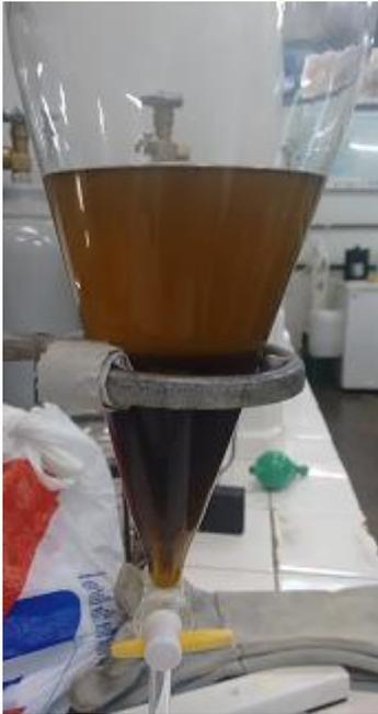
Figura 1: Biodiesel do óleo de canola neutralizado com magnesol 600R.
