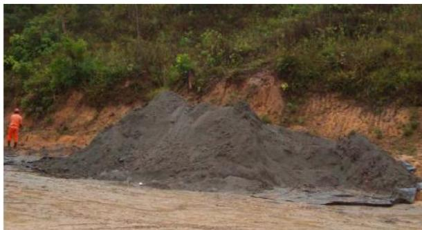
Figura 2: Figura Cascalho de perfuração estocado após processo de perfuração do poço MG – 112, Campo de Miranga, Pojuca – BA [PIRES, 2009].
