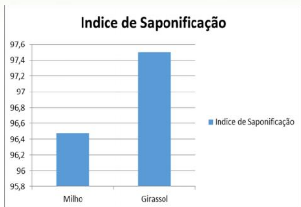
Figura 2: Relação entre os índices de saponificação do biodiesel de milho e de girassol.
