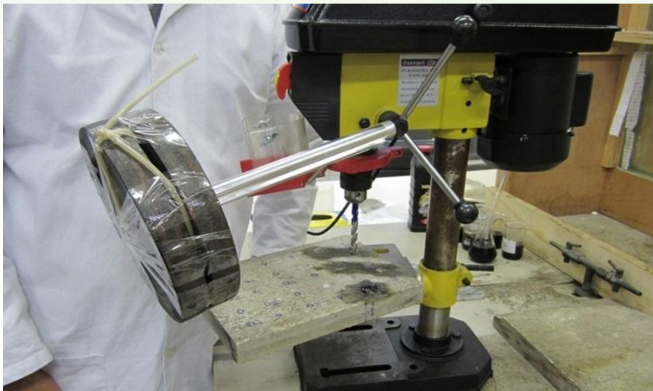
Figura 1: Furadeira de bancada com alavanca modificada pela extensão e adição de duas massas de aço com peso total constante de 10 kg procurando exercer a mesma pressão uniforme em todos os furos.
