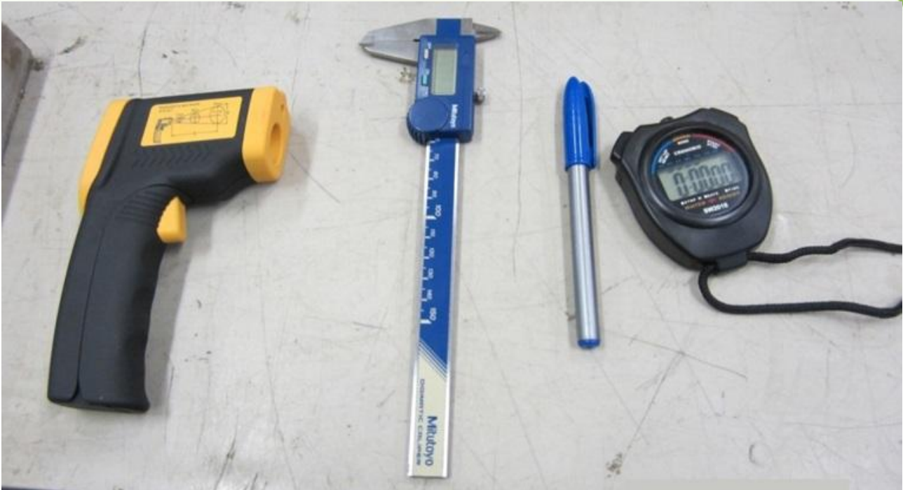
Figura 2. Termômetro digital laser infravermelho, paquímetro digital e cronômetro digital utilizado no experimento.
