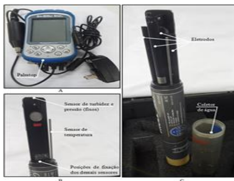
Figura 2: Sonda Multiparamétrica em conjunto com o palmtop (A), sensores (B) e eletrodos (C).
