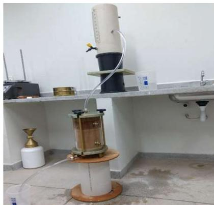
**Figura 1** – Permeâmetro do tipo 1 preparado para o ensaio. **Fonte:** Autor (2017)
