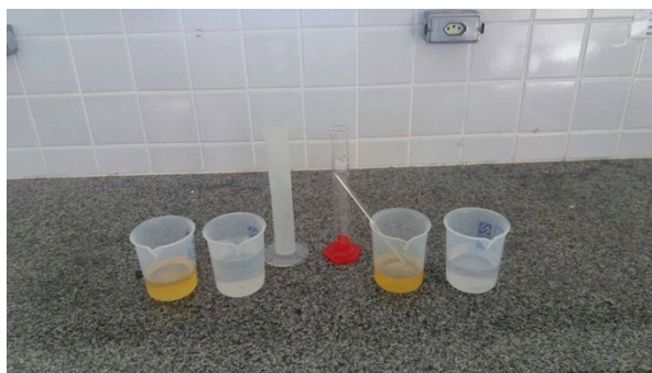
Figura 1: Materiais e reagentes utilizados no experimento adulteração da gasolina. Figura 2: Soluções de concentrações diferentes de Sulfato de Cobre (II) Fonte: Elaborada pelo autor.
