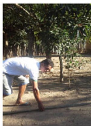
Figura 02 - Determinação da unidade de braça com o auxílio de uma vara; (b) Utilização da vara confeccionada para a medição do terreno que será utilizado.
