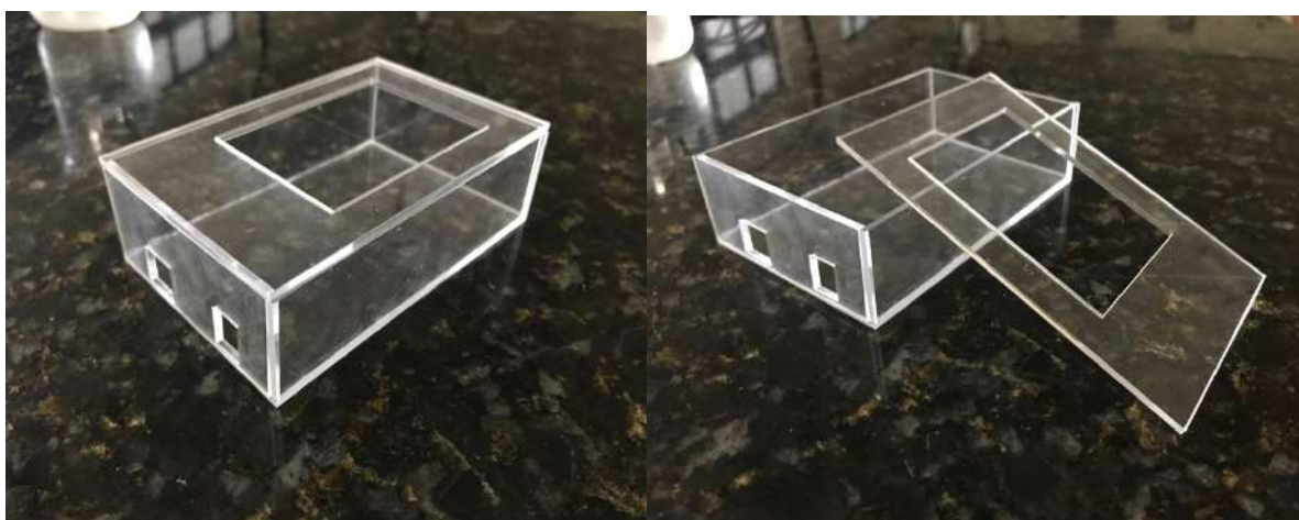
Figura 6. Caixa Estanque do Termômetro
