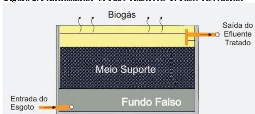
Figura 1. Funcionamento do Filtro Anaeróbio de Fluxo Ascendente
