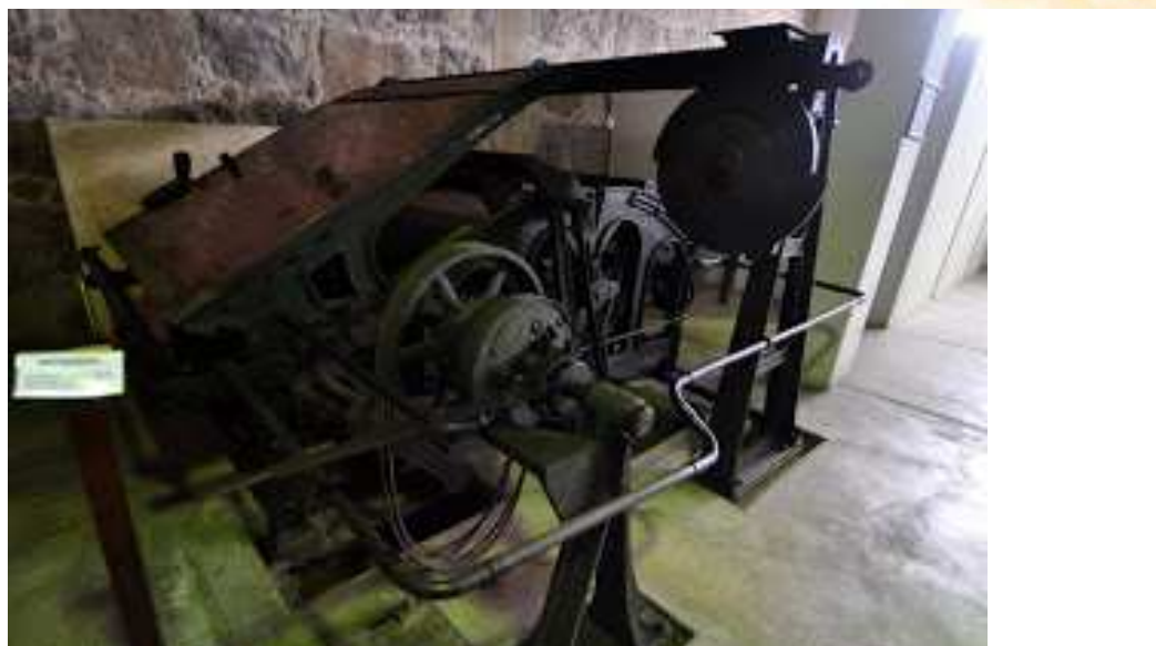
Figura 1. Metraidadeira - utilizada para medir, revisar e enrolar qualquer tipo de tecido em canudos ou tabuleiros.
